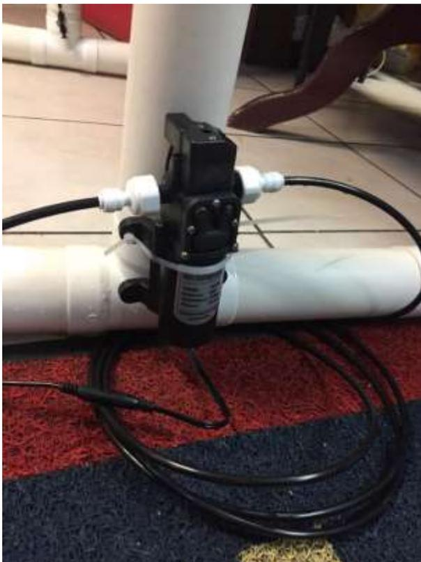
La instalación de la bomba de igual manera se ocupan los cinchos, esta se pondrá en la parte inferior contraria en donde el sistema de manguera no tenga el tapón final del circuito de aspersores.
